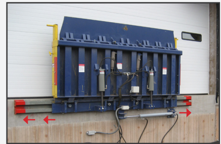
El conjunto de carro de rodillos permite el movimiento lateral para adaptarse a la posición del vagón.
